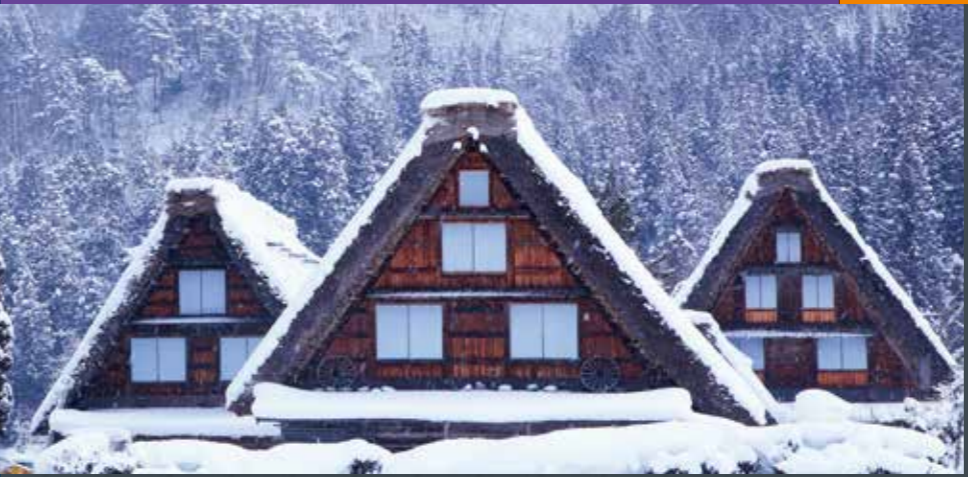
▲合掌造是日本特有的傳統建築，屋頂特別斜，夾角只有45-60度，這是因為合掌造所在地白川鄉的氣候多雨多雪，這樣的屋頂可以加速排除雨水，下雪時也能避免屋頂積雪而壓垮房屋。
